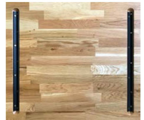
Les plateaux sont équipés de 2 rails en acier, avec des percages de type oblong afin d'éviter tout travail du bois dans le temps
