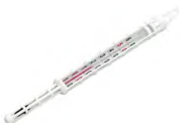
Ce thermomètre est utilisé en boulangerie. Il n'est pas rempli de mercure, mais d'un liquide rouge beaucoup moins toxique. Il est calibré pour être immergé dans toute sa partie fine. La gaine de protection peut être stérilisée à 100°C. Le thermomètre complet passe au lave-vaisselle. Peut-être suspendu par son crochet. Livré sous blister.
