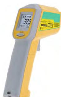
Thermomètre à visée laser .
